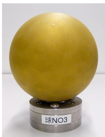
図1. 試験物体（球, \varnothing \approx 120 mm）
